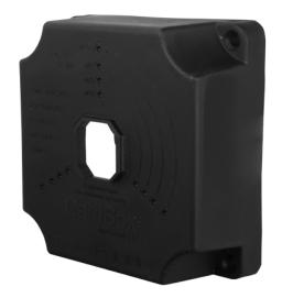
Caja de conexiones para cámaras domo y bullet Permite situar el paso interno de cableado en su interior Plástico Sellado completo con tapas CamBox 128 mm (Al) x 128 mm (Al) x 50 (Fo) mm 150 g Color negro
