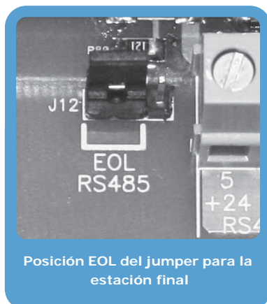
Figura 27 - Módulo SmartLevel - posición del jumper
