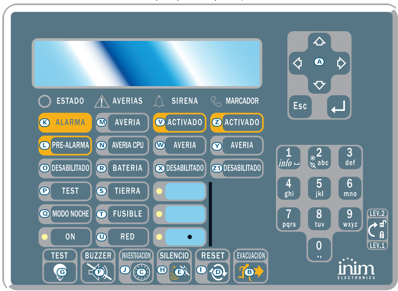
Figura 9 - Vista frontal del repetidor
